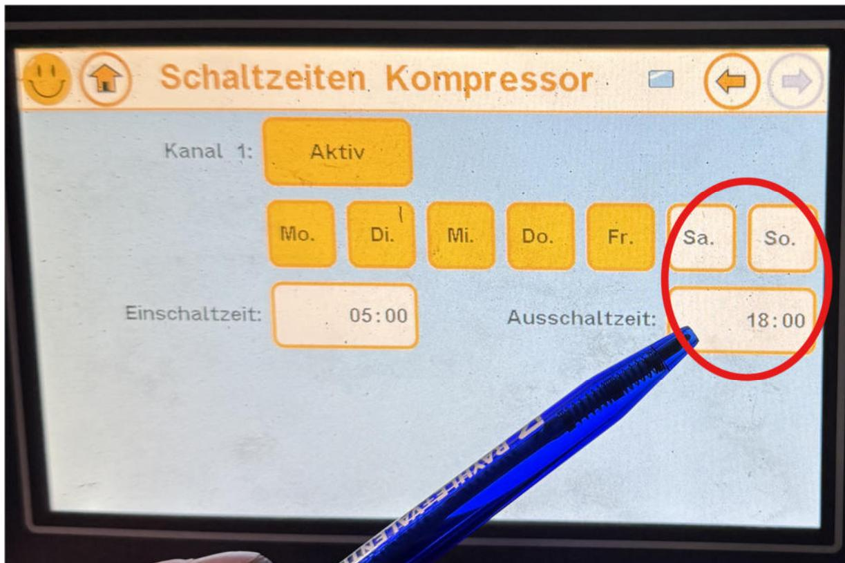
von Mo. – Fr. muss lediglich die Abschaltzeit geändert werden damit der Kompressor startet. Bsp. es ist 21:30 Uhr dann empfiehlt es sich, die Abschaltzeit auf 23:00 Uhr einzustellen. An Sa. und So. muss noch der Tag angewählt werden.
